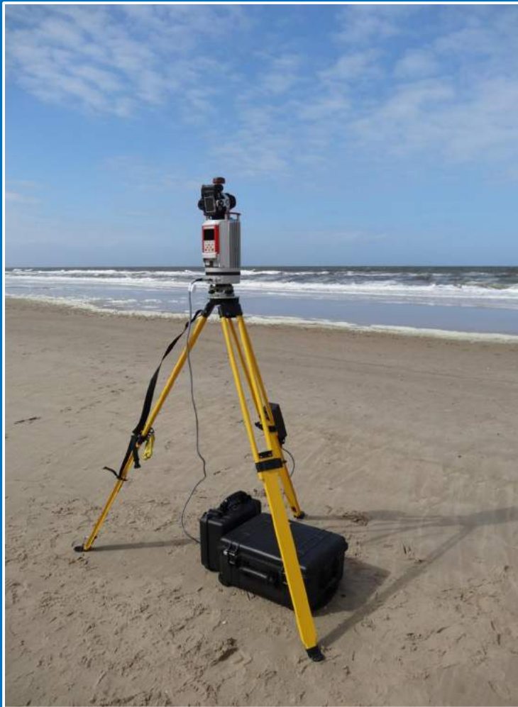
Riegl VZ-400 , 3D laser scanner Golflengte = 1550 nm
